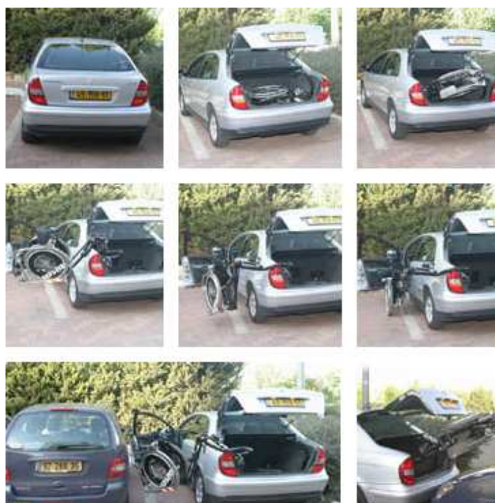
Figura 5.6 – Sequência de funcionamento do Robot 200
