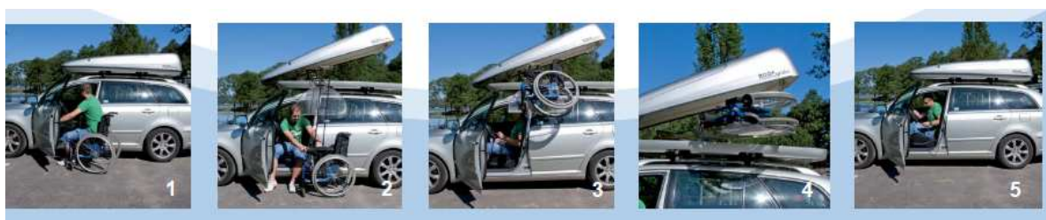
Figura 5.1 – Sequência realizada pelo Roof Spider – Adapt
