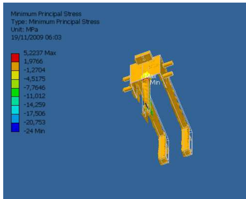
Figura 12.4 – Tensões principais mínimas em MPa
