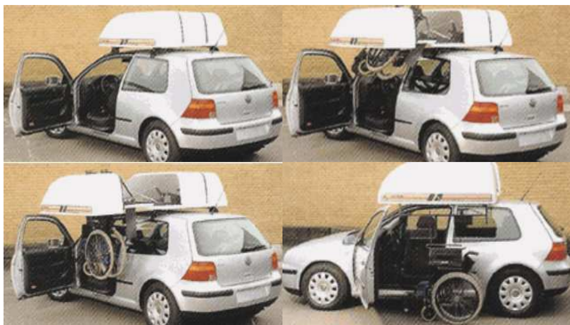
Figura 5.4 – Seqüência de funcionamento do Chair Topper
