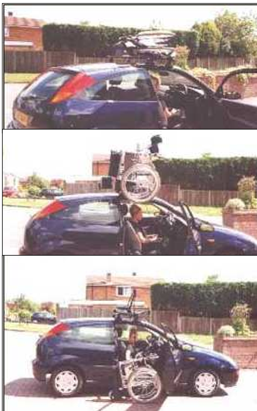
Figura 5.8 – Operação do Wymo WheelChair Hoist.
